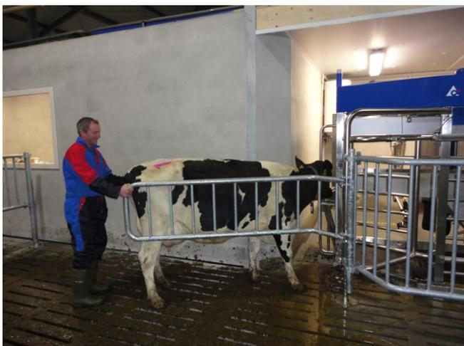
Het hek kan zonder las- en slijpwerk aan elke (bestaande) VMS gemonteerd worden. Met behulp van de kruiskoppelingen is de hoogte variabel af te stellen, al naar wens van de veehouder. De constructie is van dikwandige buis gemaakt en volledig thermisch verzinkt.
