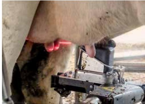
Das Rotlicht veranschaulicht die spätere Position des Melkbechers. Dadurch wird das Bestimmen der Zitzenpositionen erleichtert. Fotos: Kortenjann
