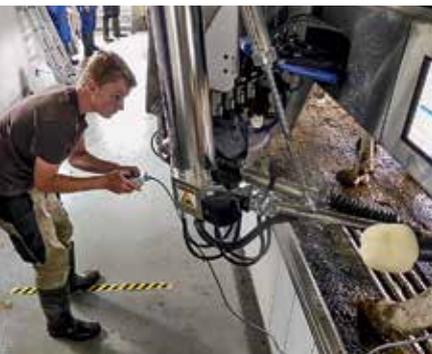
Björn Bockholt bewegt mit der Fernbedienung den Roboterarm und speichert so die Strichpositionen im Computer. Diese Information dient dann als Grundlage für das tägliche automatische Melken.
